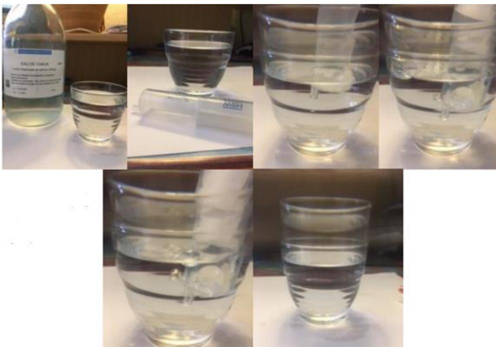
Pendant 1mn, air de la pièce aspiré dans la seringue et mis en dans l'eau de chaux.
