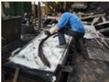
3. Fabrication des moules à partir des scans échelle 1.
