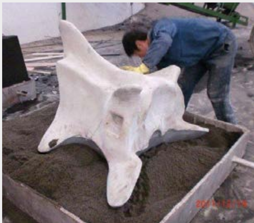
Fabrication d'un moule perdu avant la coulée d'une vertèbre.
