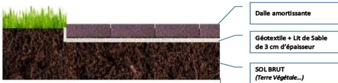
\* Le géotextile est une protection textile synthétique perméable posée au sol pour séparer l'ouvrage du sol brut. Il doit être remonté de 10 cm sur les bords, **il faut donc prévoir 10 cm de plus de chaque côté** (Exemple pour une surface d'1 m x 2 m, prévoir un géotextile 1,20 m x 2,20 m).
