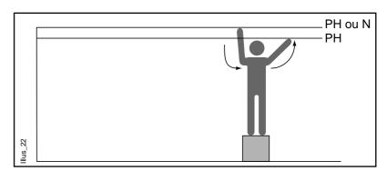
■ Contact entre : une masse mise accidentellement sous tension et un élément conducteur relié à la terre.
