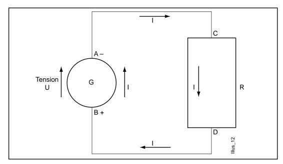
L'ensemble du circuit ACDBA comprend : un générateur G, deux conducteurs AC, DB, un récepteur R.
