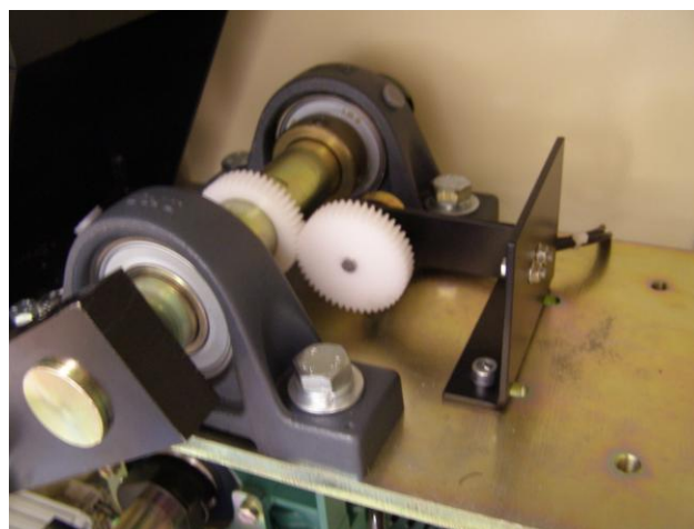
Figure 55 Potentiomètre de mesure de la position angulaire de la lisse
