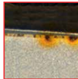
Attaque décapante des brasures. Sur ciseaux, pincettes et porte-aiguille en métal dur Cause : attaque acide suite à un surdosage des produits de neutralisation ou à l'emploi de détergents.
