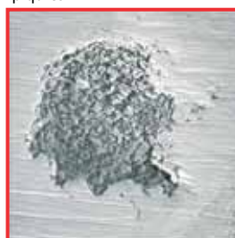
Trou de corrosion – observé au microscope électronique à balayage – grossissement 200x
