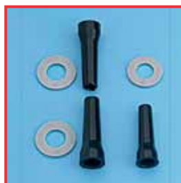
À droite : joints gonflés suite à l'application non ciblée d'huile pour instruments. À gauche : joints neufs
