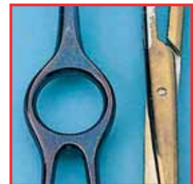
Colorations typiques dans la chambre de rinçage et sur la surface des instruments après la stérilisation à la vapeur, dues à un produit de nettoyage contenant des silicates ou à une trop forte teneur en silice dans l'eau déminéralisée.
