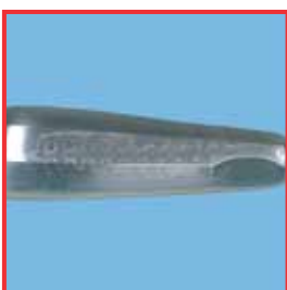
Apport de résidus de produits de nettoyage en raison d'un rinçage insuffisant
