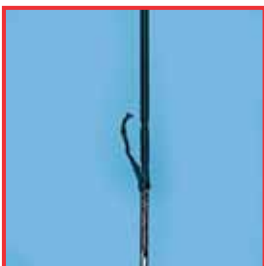
Isolation endommagée d'un instrument HF
