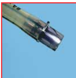
Fissure due à la contrainte
