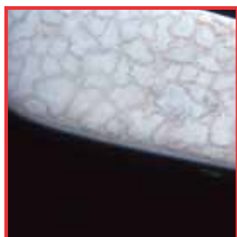
Motif de taches provoqué par des impuretés dans le condensat de vapeur.
