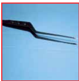
Déformation due à une manipulation non conforme
