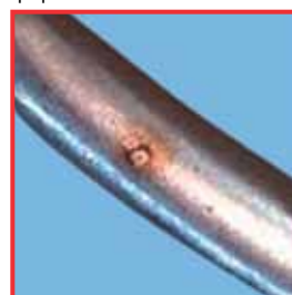
Corrosion par piqûres d'une pincette. Cause : le ruban de code de couleur étant trop vieux, il permet l'infiltration de substances nocives chlorurées.
