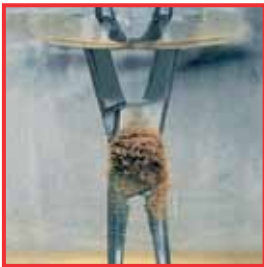
Formation de rouille due à l'immersion durant plusieurs heures dans une solution d'eau salée
