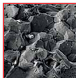
Détail : cassure de mâchoire d'une pince avec structure de rupture grumeleuse, intergranulaire typique
