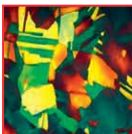
Cliché en couleurs - microstructure austénitique d'acier pour instrument inoxydable et résistant aux acides (grossissement 500 fois)
