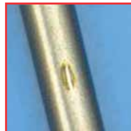
Corrosion de contact : acier inox / acier inox
