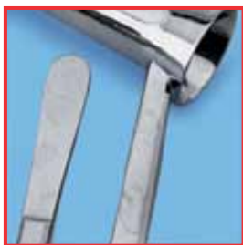
Taches en raison de la teneur en sel trop élevée de l'eau de rinçage
