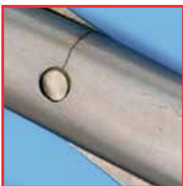
Fissures sous contrainte dans la zone d'articulation d'une paire de ciseaux
