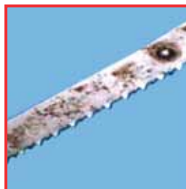
Attaque du matériau de la couche chromée partiellement défectueuse. Cause : l'humidité provoque la formation de rouille du matériau porteur non protégé en acier normal
