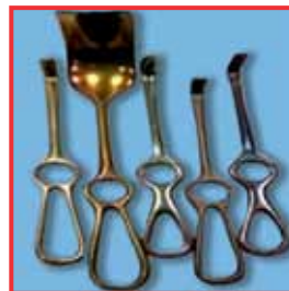
Colorations typiques dans la chambre de rinçage et sur la surface des instruments après la stérilisation à la vapeur, dues à un produit de nettoyage contenant des silicates ou à une trop forte teneur en silice dans l'eau déminéralisée.
