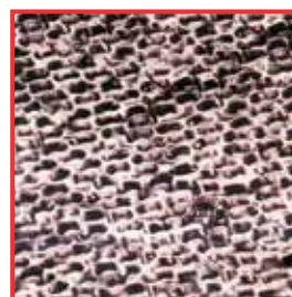
Attaque du matériau d'une poignée en aluminium. Cause : nettoyant alcalin inapproprié.
