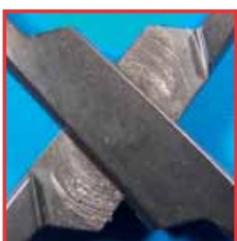
Rongement du métal suite à une application insuffisante de produits d'entretien
