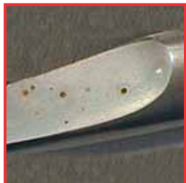
Corrosion par piqûre induite par le chlorure sur l'instrument.
