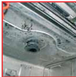
Chambre de lavage avec dépôt important de tartre
