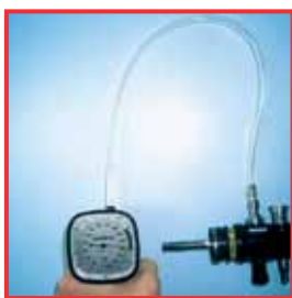
Test d'étanchéité manuel d'un endoscope flexible
