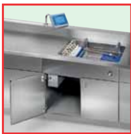
Appareil à ultrasons installé dans la zone de travail
