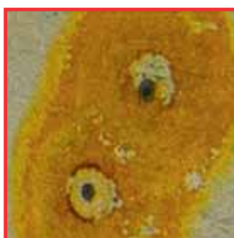
Sels de régénération à forte teneur en chlorure ayant causé une corrosion par piqûres massive sur la surface de l'instrument. Cause : raccord non étanche de l'échangeur d'ions dans le laveur-désinfecteur.
