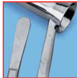
Conséquence : instruments avec résidus de calcaire
