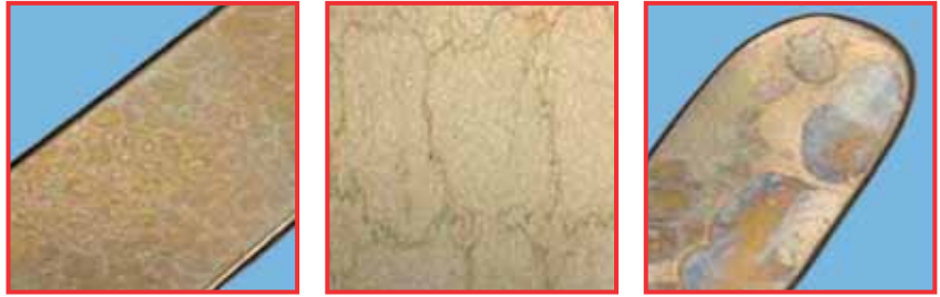
Colorations typiques dans la chambre de rinçage et sur la surface des instruments après la stérilisation à la vapeur, dues à un produit de nettoyage contenant des silicates ou à une trop forte teneur en silice dans l'eau déminéralisée.
