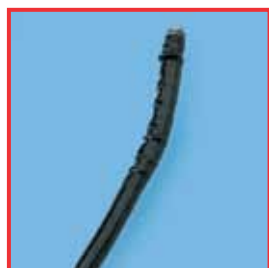
Gonflement à l'extrémité distale d'un instrument à fibre optique
