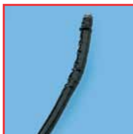
Gonflement d'un flexible d'introduction suite à l'emploi d'un produit d'entretien inadéquat.
