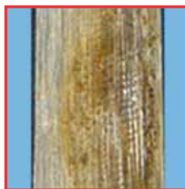
Emporte-pièce pour os, la surface de glissement du coulisseau présente des traces de corrosion par friction.
