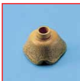
Fissure de vieillissement sur un masque respiratoire
