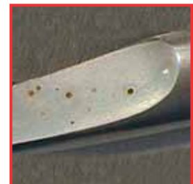
Exemple de corrosion par piqûres
