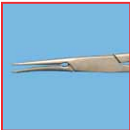
Déformation due à une manipulation non conforme
